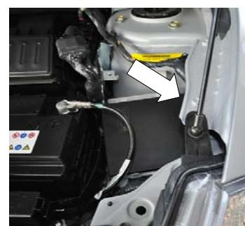
2. Установить болт-шарнир с шайбой на крыло как показано на рисунке. Затянуть болт ключом №10 с усилием 9 Нм.
