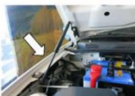
2. Установить кронштейн крыла, как показано на рисунке. Плотно прижать подгиб кронштейна к кузову и затянуть болт ключом №10 с усилием 9 Нм.
